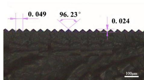
(a)  $T_{\text{mold}}: 105\text{ }^{\circ}\text{C}$   $T_{\text{subs}}: \text{room temperature}$
