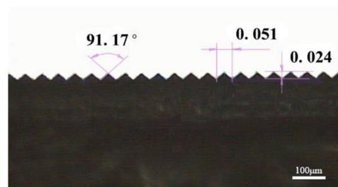
(b)  $T_{\text{mold}}: 105\text{ }^{\circ}\text{C}$   $T_{\text{subs}}: 110\text{ }^{\circ}\text{C}$
